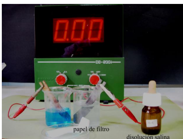
Fig.1 Montaje de la pila Daniell sin puente salino. Observe el montaje del puente salino, que consiste simplemente en un papel de filtro humedecido en una disolución de sal en agua, que conduce la corriente por la movilidad de los iones.
