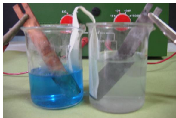
Fig.2 Montaje de la pila Daniell con puente salino
