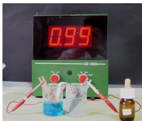
Fig.2 Montaje de la pila Daniell con puente salino
